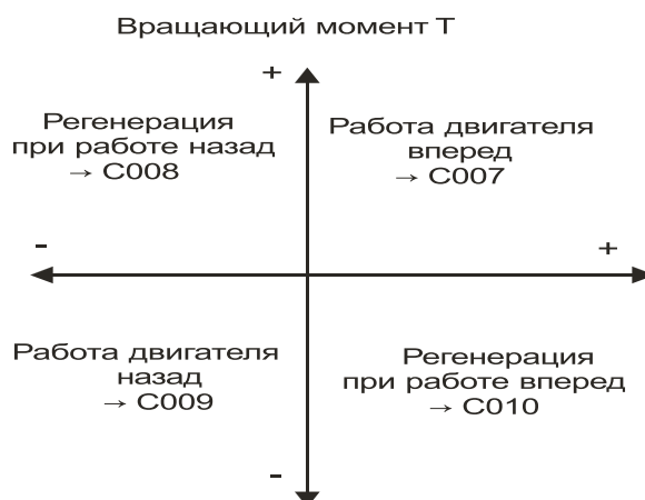
Рисунок 11-2 Предел вращающего момента (4секторный режим)
