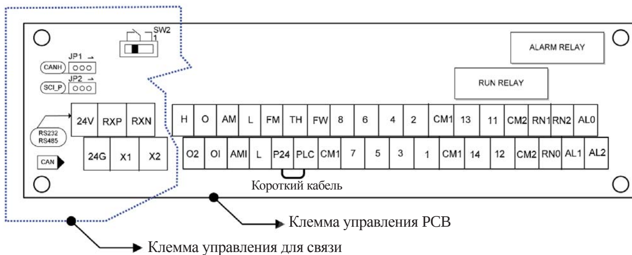
Рис. 13-2 Спецификация порта RS485 (Клемма управления PCB)
