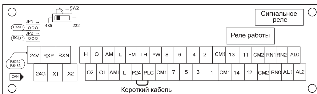
Рис. 10-1 Компоновка клемм цепи управления
