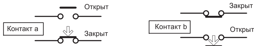
Рис. 9-7 Схема функционирования контакта а и контакта б
