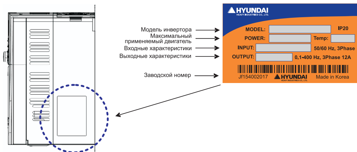
Рис. 1-2 Содержимое таблички со спецификацией
