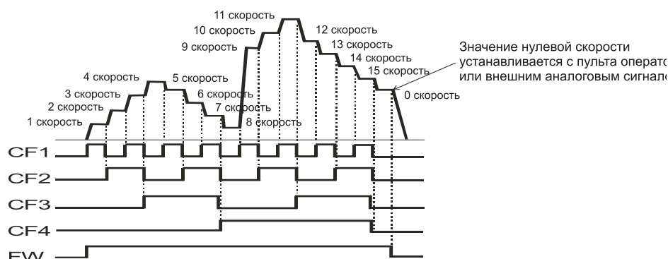
Рис. 9-10 Пример многоскоростного функционирования
