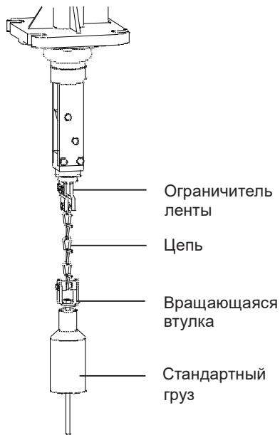
Измерительная лента пропускается через ограничитель с помощью двух винтов. Третий винт фиксирует цепь.
