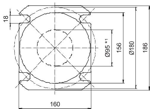
\*1 Минимальный диаметр для осуществления монтажа устройства очистки ленты и стандартного груза
