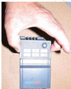
Нажать пальцами на боковые фиксаторы панели и потянуть её на себя.
