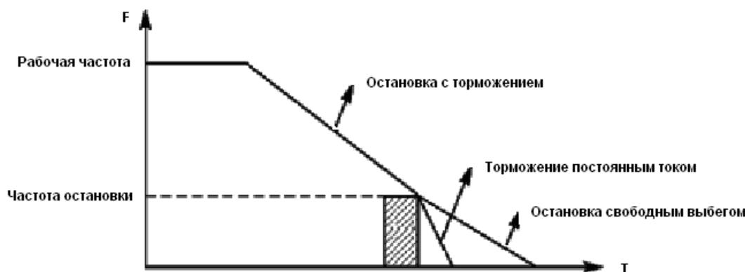
Когда торможение постоянным током неактивно, ПЧ уменьшает частоту вращения до тех пор, пока не будет достигнута частота остановки; ПЧ прекращает вывод частоты и двигатель свободно вращается до полной остановки.
