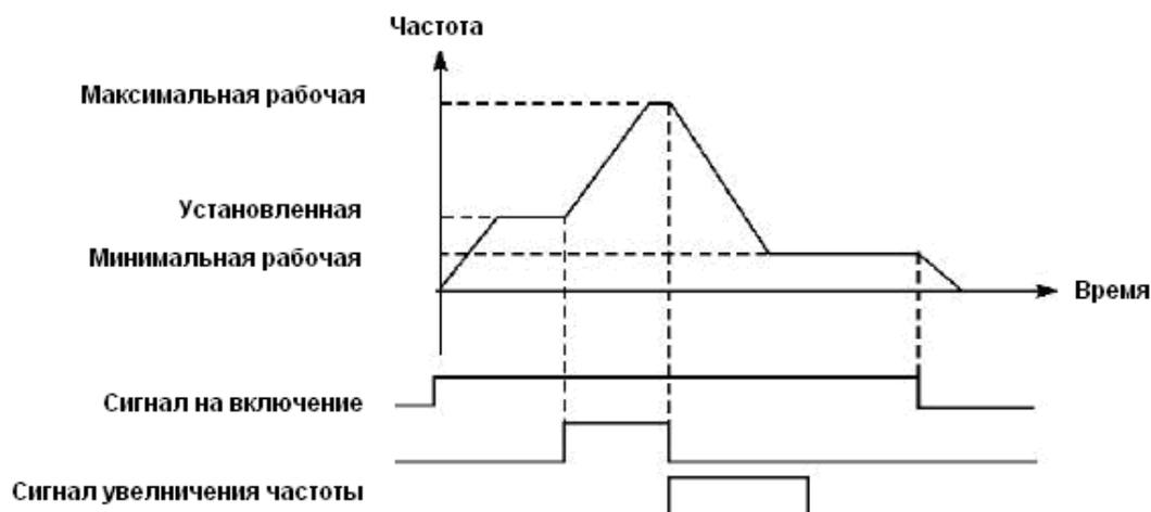
Внимание: по умолчанию изменения частоты, выполненные с помощью команд «UP» и «DOWN» не будут сохранены в памяти перед выключением ПЧ, и при последующем запуске частота будет установлена в соответствии со значением параметра Pb00. (См. также PE35)
