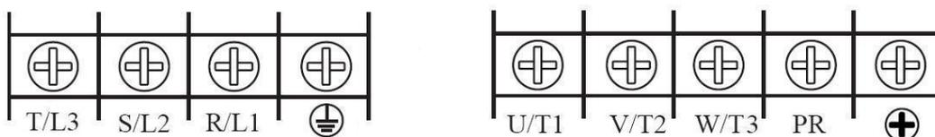
Тип корпуса 2. Трехфазные, 380 В, мощностью от 3,0 кВт до 5,5 кВт, а также однофазные, 220 В, мощностью от 2,2 кВт до 3,7 кВт (используются клеммы S и T):
