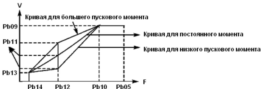
P<sub>b</sub>09: V/F-кривая: максимальное напряжение. Максимальное напряжение должно быть установлено в соответствии с моделью двигателя. В большинстве случаев это номинальное напряжение двигателя, но когда двигатель находится в пределах 30 м от ПЧ, следует установить немного большее значение.
