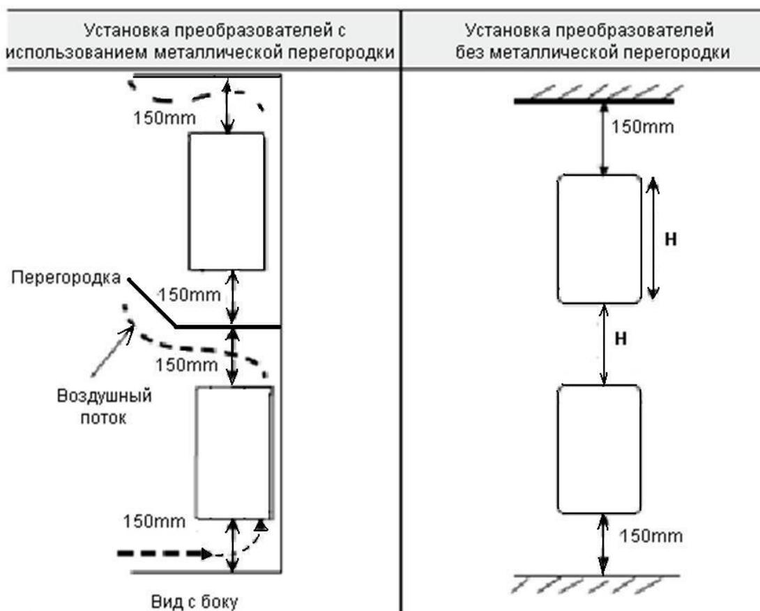
Перед монтажом нескольких ПЧ в один шкаф управления убедитесь, что в нем достаточно свободного пространства, имеется хороший теплообмен. Если преобразователи установлены рядом друг с другом, то расстояние между преобразователями должно быть больше 50 мм.
