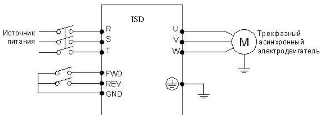
Параметр: P<sub>b02</sub>=1, P<sub>d15</sub>=6, P<sub>d16</sub>=7
