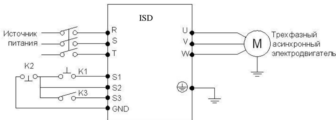
(2) Настройка параметра PF33 определяющего направления вращения
