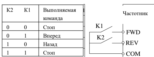
Рис.6-13 Двухпроводной режим управления 1
