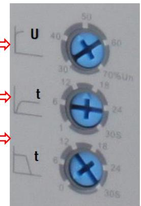
Регулировка времени разгона 1-30с
